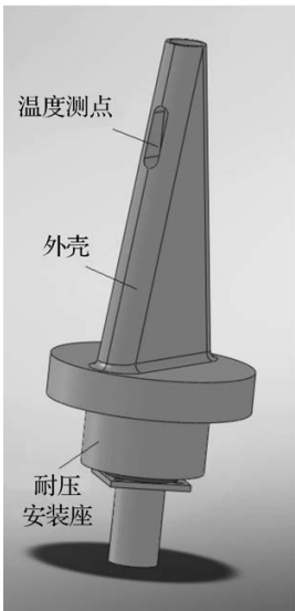
图 1 耐压环境总温传感器示意图
