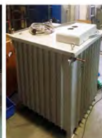
高压电源逆变器和高压油箱
