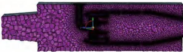
图3 中心分级燃烧室内部网格
