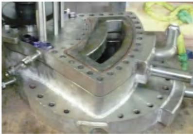
图3 多头部扇形燃烧室试验件照片
