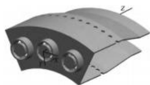
图7 上海交通大学发展的多旋流RQL燃烧室 [44]
