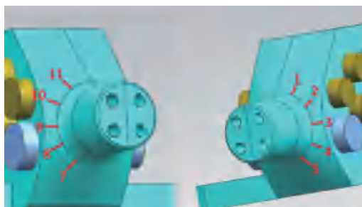
图4 支撑梁前端的应变片粘贴位置
