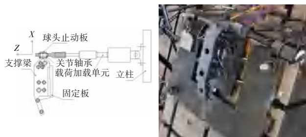
图5 支撑梁载荷标定试验方案及试验现场照片
