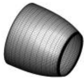
图4 后体外壁面 结构化网格
