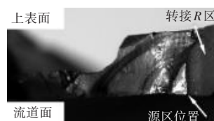
图 2 掉块断口宏观形貌
