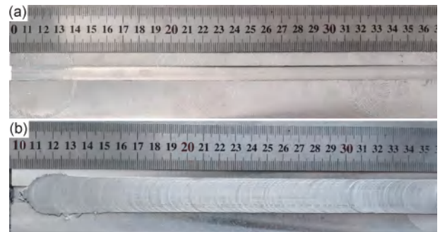
图 3 W-FSAR 修复前后宏观形貌
