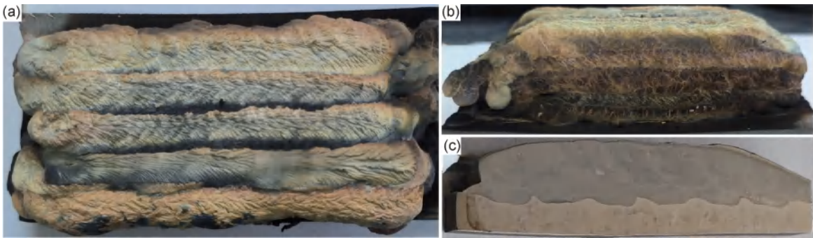
图 4 NiTi 合金沉积件宏观形貌图
