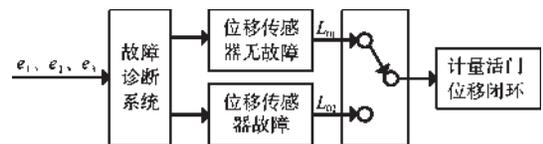
图 7 位移传感器故障主动容错控制原理
