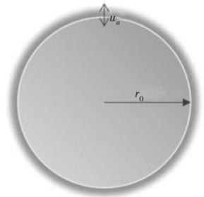
图1 单极子脉动球源模型
