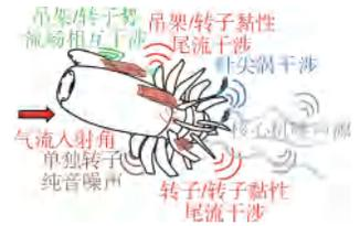
(a) 开式转子发动机噪声源<sup>[18]</sup>
