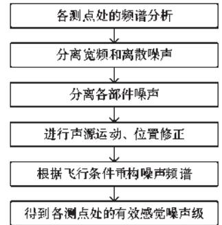
图 4 ICAO Doc9501 中建议的地空映射程序<sup>[26]</sup>
