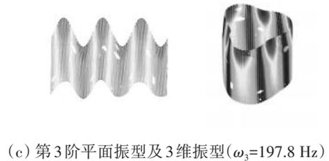
(c) 第3阶平面振型及3维振型( $\omega_3=197.8$  Hz)
