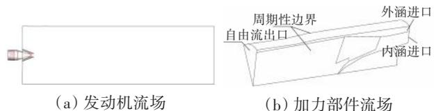
图 3 发动机流场仿真计算域模型
