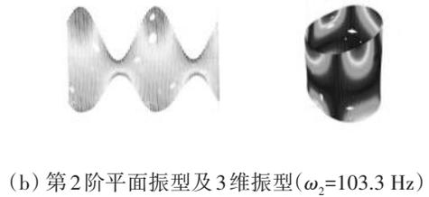
(b) 第2阶平面振型及3维振型( $\omega_2=103.3$  Hz)
