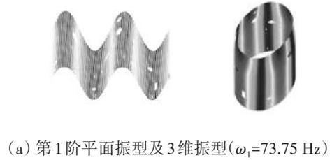
(a) 第1阶平面振型及3维振型( $\omega_1=73.75$  Hz)
