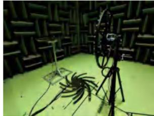
图 8 消声实验室试验台布置
