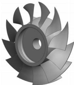
图1 轴流压气机叶轮
