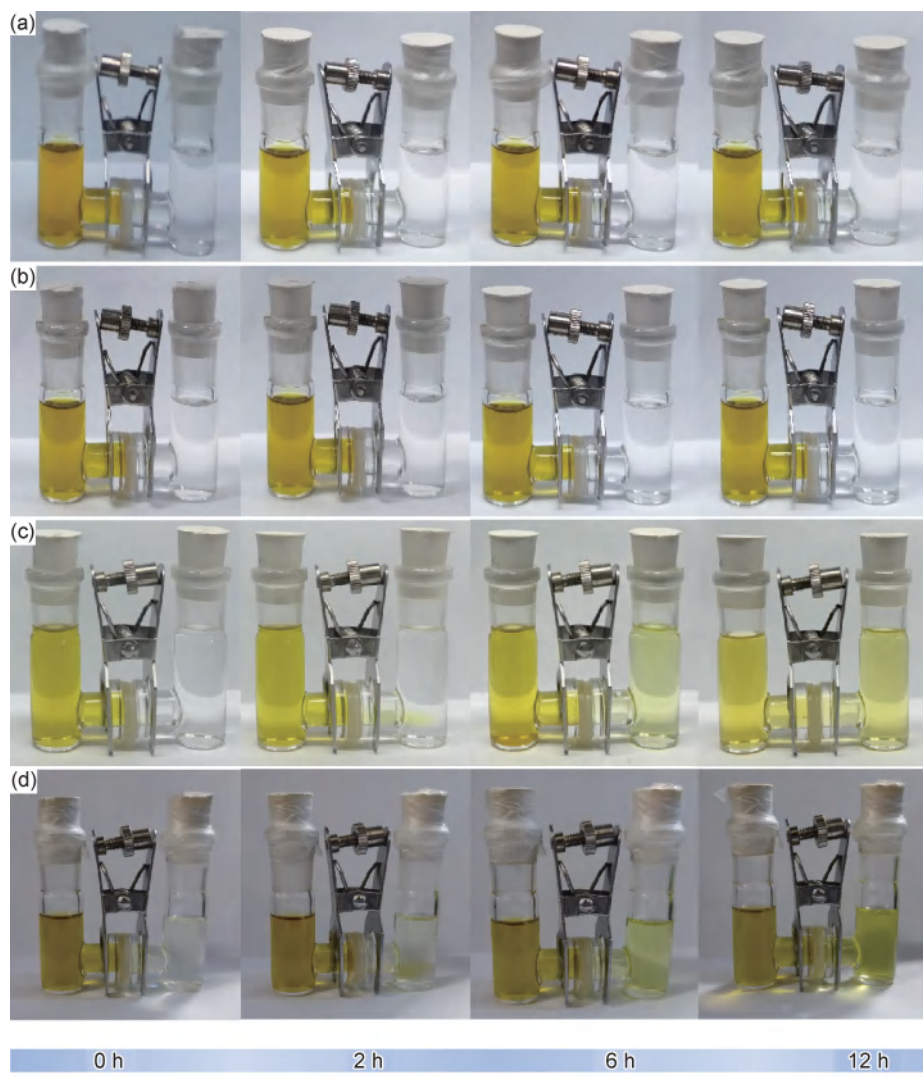
图3 Ce-UiO-66/Celgard(a)、Zr-UiO-66/Celgard(b)、rGO/Celgard(c)及原始Celgard PP(d)对 \text{Li}_2\text{S}_6 迁移效果实物图
