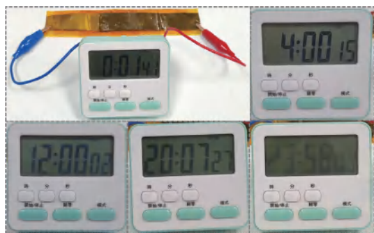
图9 准固态 Zn|DSMCAK 驱动电子表照片
