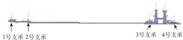
图4 真实转子有限元计算模型 Fig.4 Finite element calculation model of true rotor
