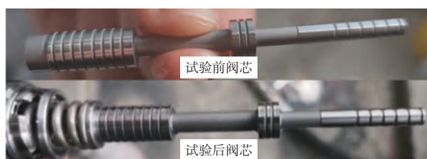
图15 试验前后阀芯实物对比照片
