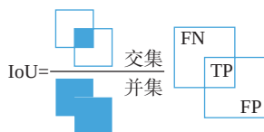
图 10 IoU 定义 Fig.10 IoU definition
