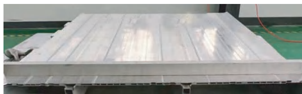
(b) 采用SDS-FSW焊接 (正反面同时FSW→打磨飞边)
