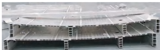
(a) 采用CDS-FSW焊接 (正面FSW→打磨飞边→压力机矫形→反面FSW→打磨飞边→最后整形)
