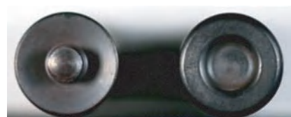
上搅拌头形貌 下搅拌头形貌
