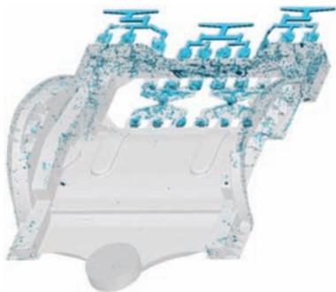
图3 Magma 软件预测的缺陷分布模拟结果<sup>[40]</sup>
