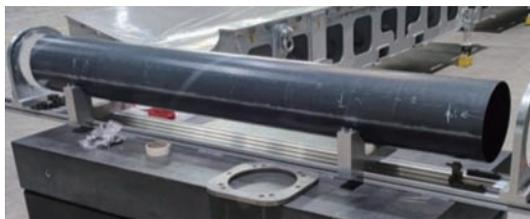
(b) 圆管梁样段试验件
