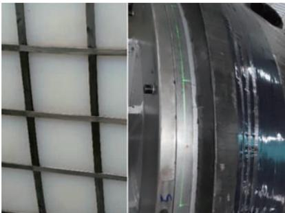
图 18 筋条及端框铺设局部图
