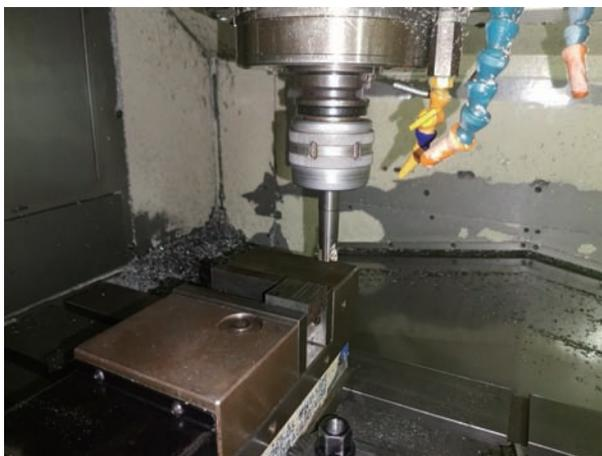
图 1 单因素端铣试验
