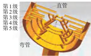
图2 掺混器结构
