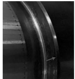
图3 内衬套端面磨损形貌
