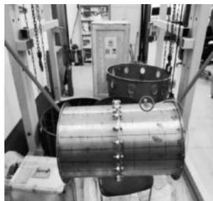
使用锤击法进行模态试验,获得圆筒螺栓连接结构的自由振动频率和振
