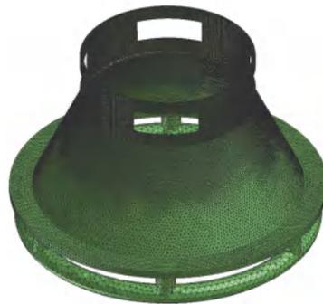
图6 铸件和浇注系统的有限元模型
