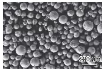
图 1 CoNi 基高温合金粉末微观形貌
