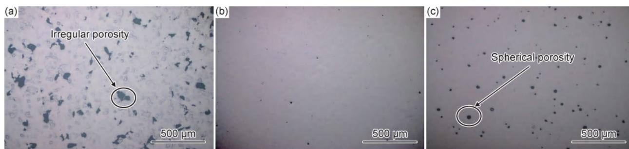
图5 不同参数下SLM成形TCGH复合材料缺陷形貌及缺陷占比
