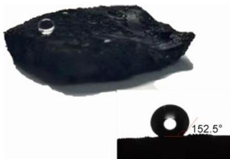
图 9 水滴在 GPCS-HHA 表面的照片及接触角
